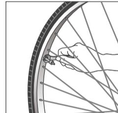
2 タイヤレバーの薄くなっている方をタイヤとリムの間に差し込んでおこし、タイヤレバーの切れ込み部分をスポークにかける。
