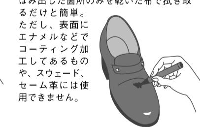
3 擦り減った部分に補修剤を絞り出し付属のヘラで伸ばす。この補修剤は3mmの厚さが固まるのに24時間かかるので、擦り減りが深い場合は、3mm埋めたら24時間おいて次の日にもう一度塗る、を繰り返すようにする。
