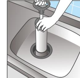
水の圧力でゴミを押し流す道具には吸引カップのほかに、竹製の水てっぽうを大型にしたようなポンプ式の器具や、強力な吸引力と押し下げ圧力でゴミを押し流す真空式のものがあります。
